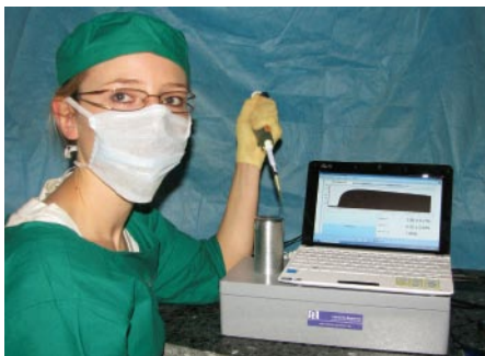
Abb. 5: Prototyp des Messgeräts für die direkte Heparinbestimmung in klinischen Test
